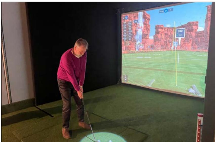
Die Technik moderner Simulatoren ist inzwischen durchaus beeindruckend. Die hoch entwickelten Sensoren, Radarmessungen, die gesamte Elektronik errechnet aus den Komponenten des individuellen Schwunges wie etwa der Schlägerkopfgeschwindigkeit, der Spin-Rate, dem Impact oder der Schwungebene einen Ballflug von verblüffender Realitätsnähe. Ein saftiger Slice ist auf der Leinwand ebenfalls als solcher zu erkennen.
